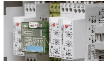
sichergestellt, dass diese Schaltung keinen Ruhestrom benötigt, der längerfristig die Fahrzeugbatterie entlädt. Des Weiteren werden durch ComatReleco-Relais Signale vom Brandmeldesystem oder dem Energiemanagement des Fahrzeugs weitergeleitet oder verschiedene Betriebszustände des Zuges, wie beispielsweise «Fahrerstand besetzt», «Zug besetzt» oder «Schleppbetrieb aktiv», gespeichert.
