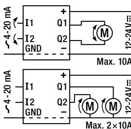
Motordrehzahl einstellbar über integriertes Potentiometer
