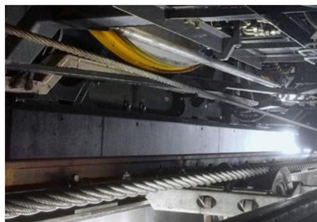
■ La tension électrique du câble de traction du funiculaire est mesurée à la station inférieure et comparée avec celle de la station supérieure. Des divergences de tension entraînent une immobilisation du funiculaire.
