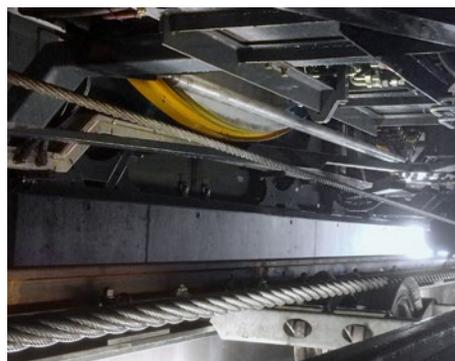
■ Die elektrische Spannung des Zugseils der Standseilbahn wird in der Talstation gemessen und mit derjenigen der Bergstation verglichen. Abweichungen in der Spannung stoppen die Bahn.
