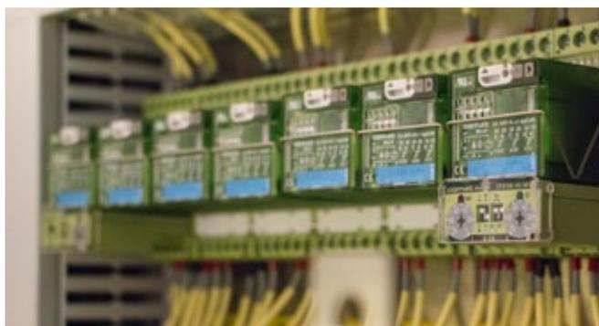
Diese Relais mit 3 Wechslern werden für diverse Steuerfunktionen im Zug eingesetzt. Zum Beispiel wird beim Betreten eines ausgeschalteten Fahrzeugs ein Schalter betätigt, der Notbeleuchtung und Türsystem einschaltet. Die Steuerung dahinter wird durch Comat-Relais realisiert.
